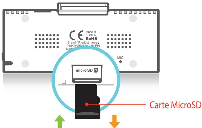
Insérez la carte MicroSD dans le port avec les contacts métalliques dirigés vers l'arrière de l'appareil, puis poussez-la jusqu'à ce qu'elle se verrouille en place avec un déclic.
