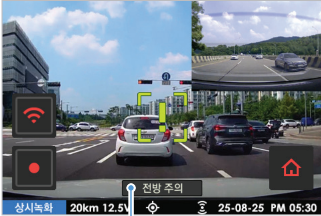
1차 저속 전방 추돌 경고: 초기 저속 전방 추돌 위험을 감지할 때 표시됩니다.
