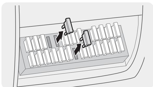
打開保險絲盒，使用試電筆找到循環電源終端（在車輛熄火時供電）以及 ACC 終端（點火狀態為「ACC ON」時供電），將保險絲從終端上拆下。
