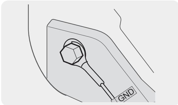
連接地線（GND 線）至附在車身金屬部件上的螺栓。
