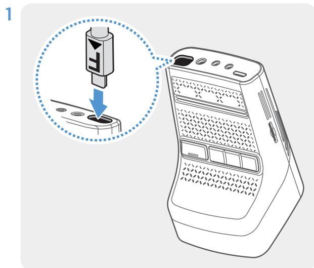
連接後方記錄儀纜線的一端（標誌為 **F**）至前方記錄儀的 V-IN 端口。
