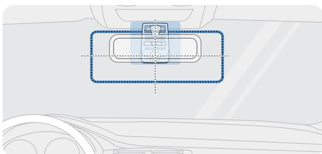
選擇可以錄製車輛前方整個視野且不遮擋駕駛人員視線的安裝位置。確保前方記錄儀鏡頭處於擋風玻璃的中心。
