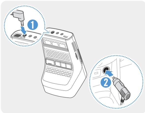
連接汽車充電器至產品的 DC-IN 電源端口並將雪茄插孔插入車輛的電源插座。
