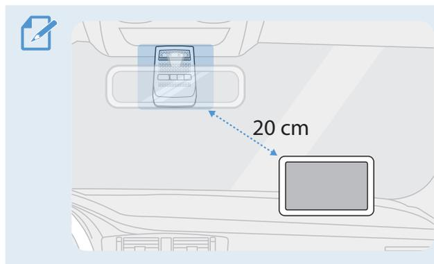
若儀錶板上安裝了 GPS 導航裝置，視乎儀錶板記錄儀的安裝位置而定，其 GPS 訊號接受可能會受到影響。調整 GPS 導航裝置的安裝位置以確保兩個裝置相距至少 20 厘米（約 8 英寸）。
