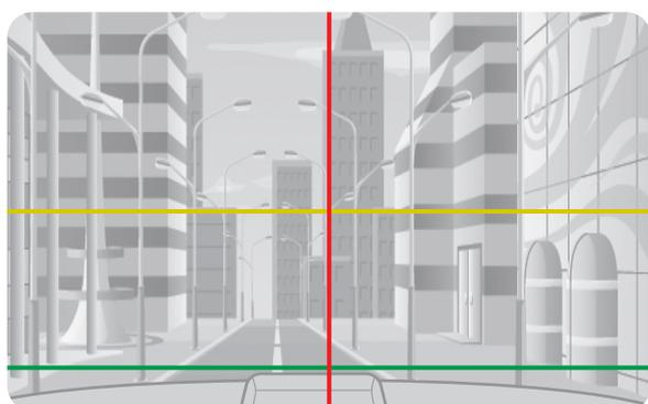
附加後方記錄儀時，使用流動檢視器應用程式檢查即時影像。在您的智能手機上啟動 **THINKWARE DASH CAM LINK** 並輕觸**即時影像** > **後**以切換螢幕至後方視野。將紅線與記錄儀的中心對齊，將黃線與水平線中心對齊，將綠線與主幹線對齊。
