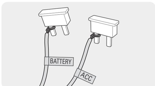
連接電池線至循環電源終端的保險絲支撐腳並連接 ACC 線至普通 (ACC) 終端的保險絲支撐腳。
