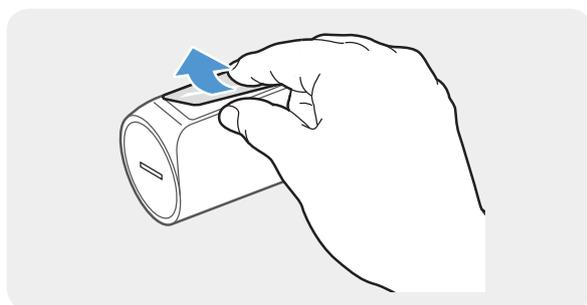
Retirez le film de l'arrière du module RADAR.
