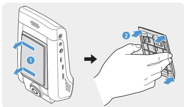
Retirez l'appareil du support et appuyez le support sur le pare-brise pour vous assurer que le support est fixé solidement.
