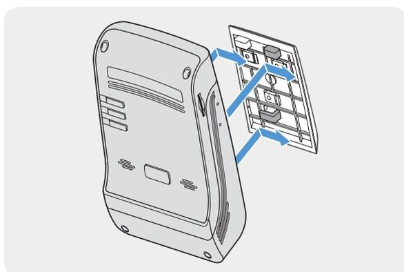
Alignez l'appareil avec le support, puis faites-le glisser en position de fixation jusqu'à ce que vous entendiez un déclic.
