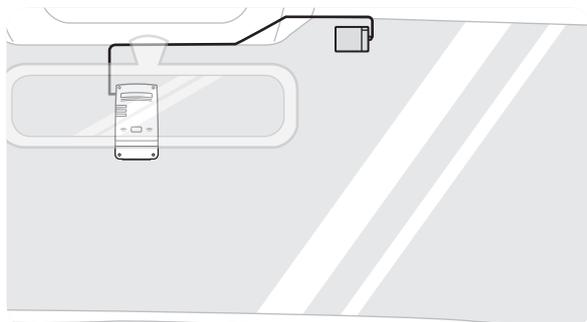
Placez la surface adhésive du module RADAR dans le haut du pare-brise, puis appuyez fermement sur la partie adhésive pour la fixer.
