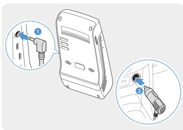
Branchez le chargeur pour véhicule à la prise d'alimentation DC-IN de l'appareil, puis insérez la fiche pour allume-cigare dans la prise d'alimentation du véhicule.
