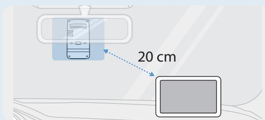
Si un appareil de navigation GPS est installé sur le tableau de bord, la réception du signal GPS pourrait être affectée selon l'emplacement d'installation de la caméra de tableau de bord.
