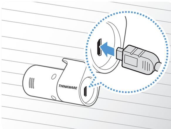
Branchez l'autre extrémité du câble de la caméra arrière au connecteur de la caméra arrière.
