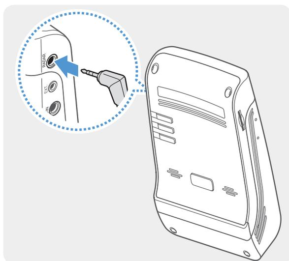
Raccordez le module RADAR au connecteur RADAR du produit.
