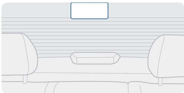
Choisissez un emplacement d'installation sur la lunette arrière qui n'est pas dans la grille du dégivreur et qui permet à la caméra d'enregistrer toute la vue arrière du véhicule.
