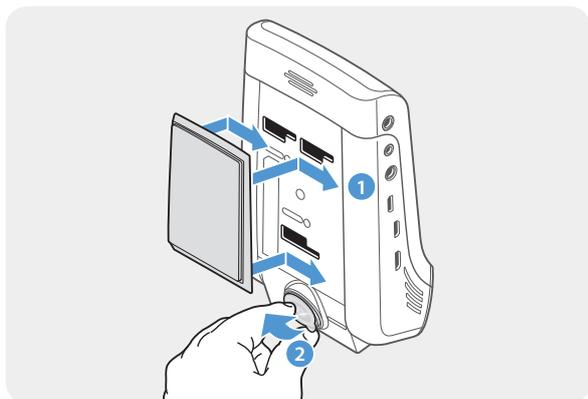
Alignez le support avec le rail du support sur l'appareil, puis faites-le glisser jusqu'à ce que vous entendiez un déclic (1). Ensuite, retirez le film protecteur avec précaution (2).
