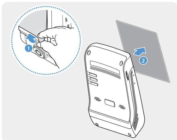
Retirez le film protecteur du support adhésif, puis appuyez le support sur la surface de l'emplacement d'installation.
